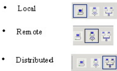
Рис. 16.19. Кнопки на панели HFSS, позволяющие оперативно переключать режим локальной, удаленной и распределенной работы
