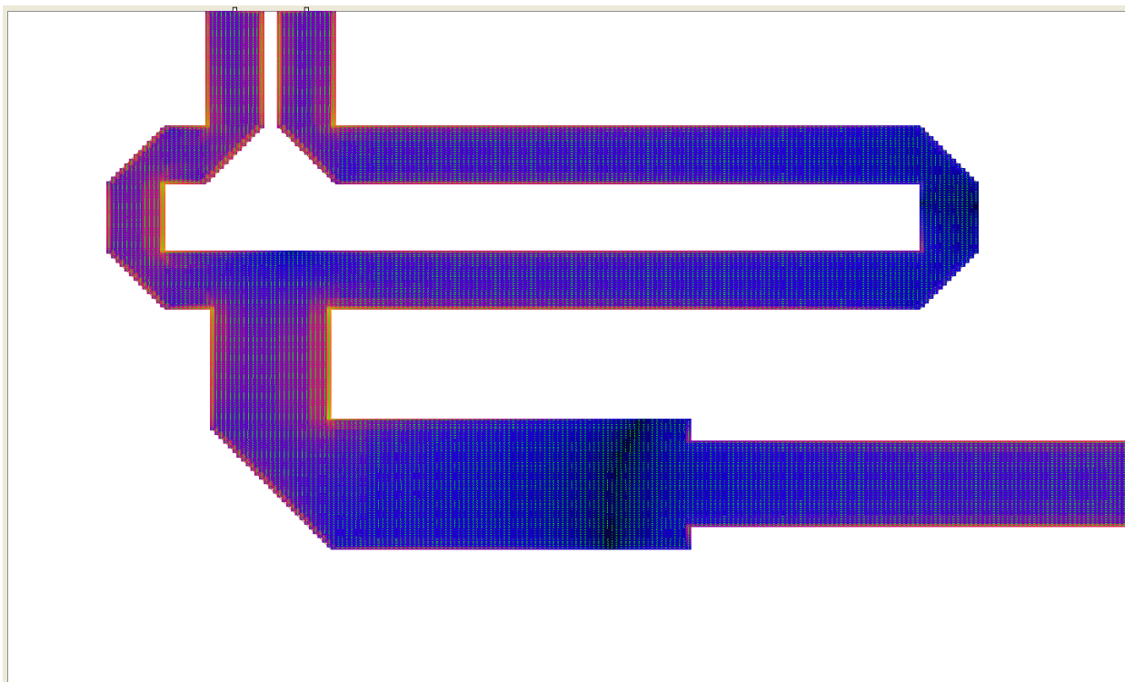
Рис. 4.19. Распределение токов на полосковых проводниках возбуждителя
