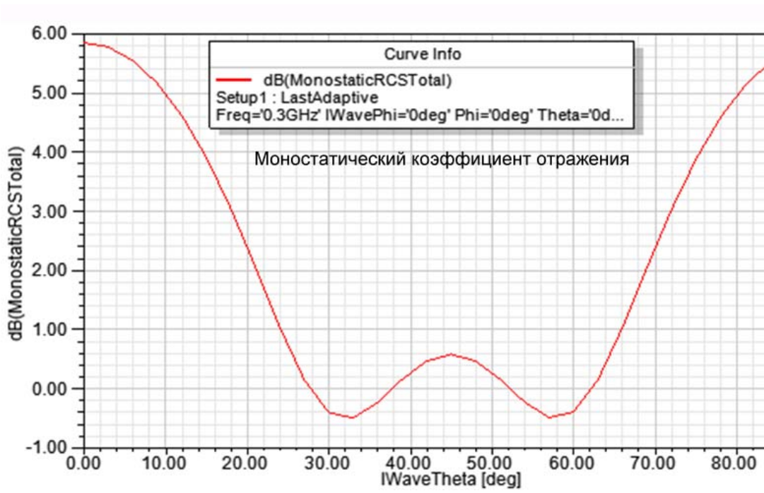
Рис. 6.20. Зависимость RCS от угла падения падающей плоской волны (моностатический режим)
